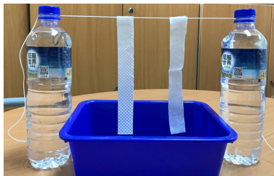
圖 4 JT3 設計之毛細現象實驗裝置
