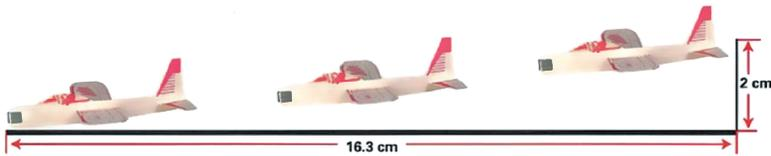
上圖有三張連續照片，圖中滑翔機是實驗用模型，在短時間內拍攝三張照片就可以判斷飛行途徑。
